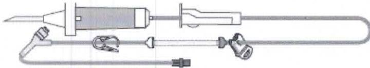
**ICASET® EI 0623 CT00** Equipo para nutrição enteral com conector em cruz, câmara gotejadora intermediária flexível sem filtro e sem entrada de ar, pinça rolete, tubo na cor roxa, corta fluxo dedicado, trecho de silicone, conector escalonado para alimentação enteral com protetor, comprimento de 2,52 m e prime de 16,0 ml.
