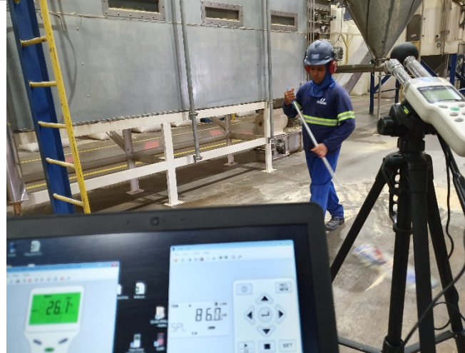
Foto 3 – Medição de Ruído e Calor.
